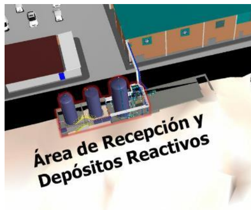
Figura 28. CAT: MD. PT Lixiviados – Recepción y depósitos. (Cabildo de Tenerife)
