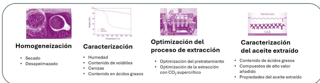
Figura 1. Proceso seguido en ITENE para la extracción de aceites a partir de residuos de posos de café (ITENE)
