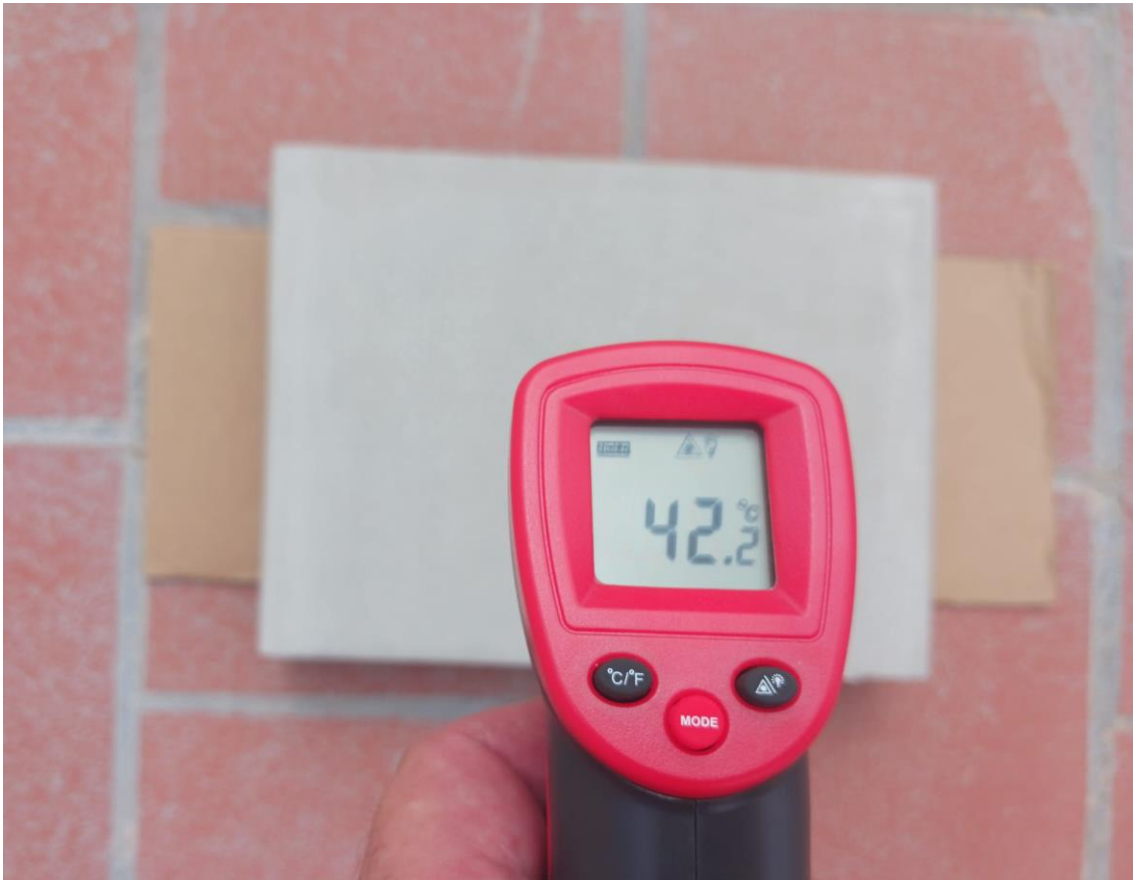
Figura 2. Medición termómetro infrarrojo 14h, pieza de hormigón sin tratamiento termorefectante. [2]
