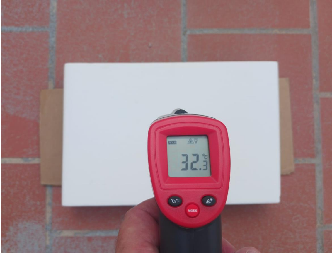
Figura 3. Medición termómetro infrarrojo 14h pieza de hormigón con tratamiento termorefectante. La diferencia de temperatura una vez aplicado el tratamiento termorefectante es prácticamente de 10 ° C [3]
