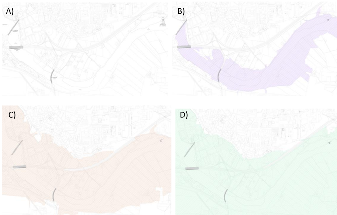
Figura 1. A) Plano actual B) Inundabilidad en 10 años C) Inundabilidad en 100 años D) Inundabilidad en 500 años (Ayuntamiento de Andújar)
