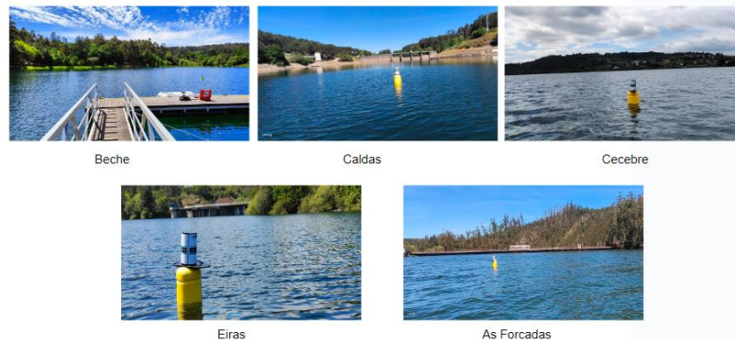
Figura 4. Boyas multiparamétricas instaladas en el marco del proyecto en diferentes embalses
