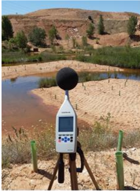
Figura 2. Escena de la laguna grande de La Chanta y primer plano de un sonómetro integrador de clase 1 (marca Cesva, modelo SC420), instalado sobre un trípode para realizar mediciones en bandas de octava entre 16 Hz y 16 kHz. (Fotografía: Carlos Iglesias)
