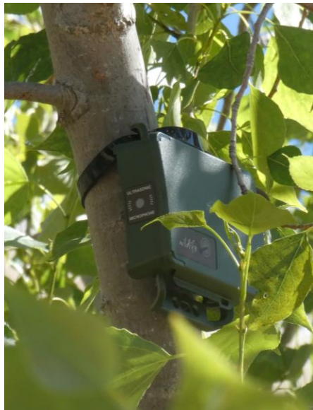
Figura 3. Grabadora programable tipo Song Meter Mini Bat de la empresa Wildlife Acoustics, que consta de un micrófono ultrasónico y un micrófono acústico. En la configuración empleada, capta el sonido ambiente hasta una frecuencia de 12 kHz y permite identificar contaminación acústica así como sonidos de diferentes grupos animales y de la geofonía. (Fotografía: Carlos Iglesias)
