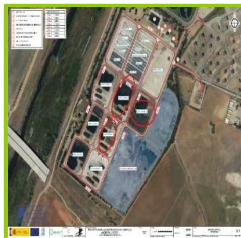
Figura 1. Señalización eras de hormigón a demoler (EMASESA)
