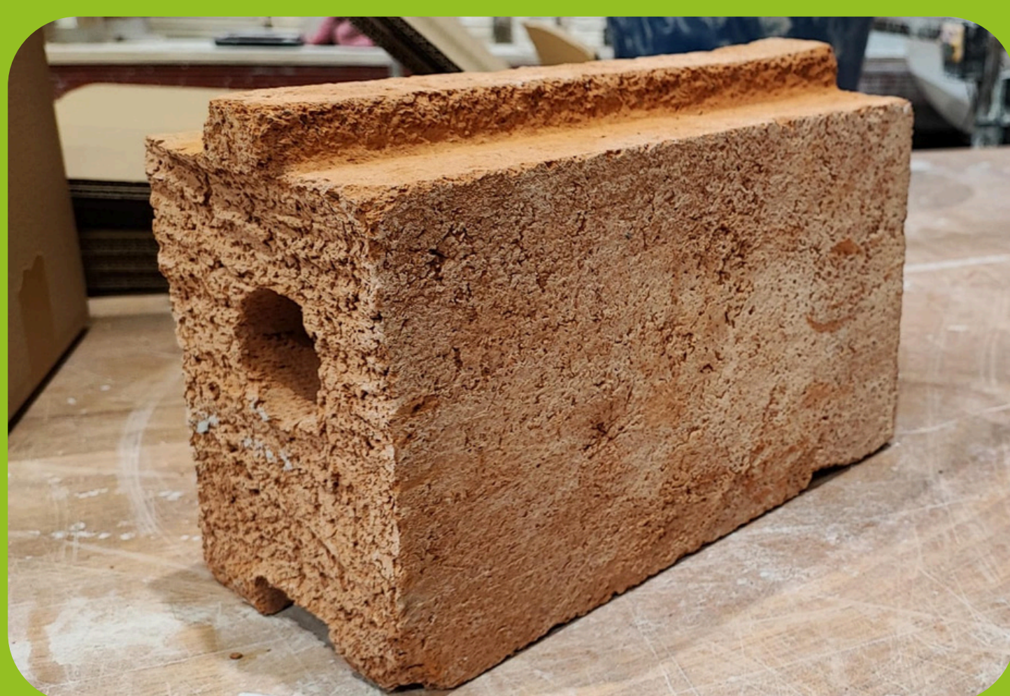
De izquierda a derecha: bloque de tierra comprimida, BTC, fabricado a escala real con la incorporación de un 85% de lodos de dragado del Guadalquivir; Impresión 3D de materiales bioclimáticos con la incorporación de lodos; y diferentes porcentajes de aditivación de lodos de dragado V1 (toma de muestras de Vaciaderos Butano de 2020), y V2 (toma de muestras de Vaciaderos Butano de 2023), sobre mezcla de arcillas de referencia (izquierda), hasta porcentajes de mezclado más adecuados (derecha), a 1160°C de temperatura máxima de sinterización (arriba), y 1080°C (abajo).
