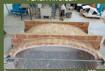
Ensayo prueba de carga bóveda de BTC con costillas
