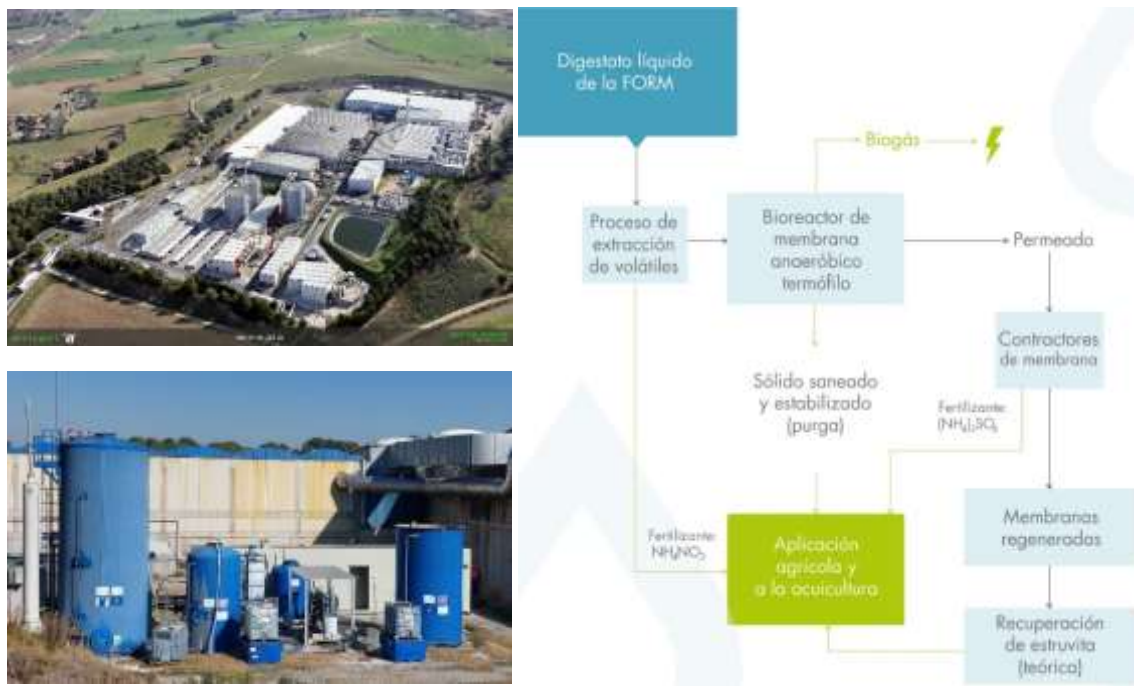
Figura 2. Imagen aérea de Ecoparc 2 (izq. sup.), prototipo de LIFE INFUSION en Ecoparc 2 (izq. inf.) y esquema de proceso de la solución LIFE INFUSION en Ecoparc 2 (dcha.)
