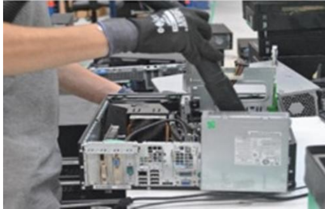
Figura 1. Desmontaje manual del equipo para su inspección preliminar.
