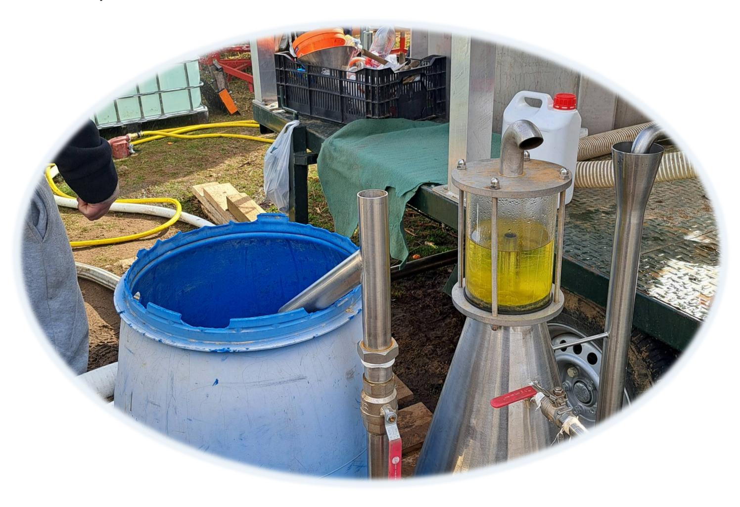
Las destilaciones se llevaron a cabo los días 6 y 7 de febrero de 2024 en los equipos de destilación que se posicionaron en las cercanías del pueblo de El Ordial y a menos de 1.000 m. del tajo. Los equipos constan de un remolque con generador de vapor (300 kg/h), otro remolque con dos vasos de destilación con capacidad de 1250 kg cada uno y uno de condensación que incluye el serpentín y un camión con grúa para la carga y descarga de la biomasa
