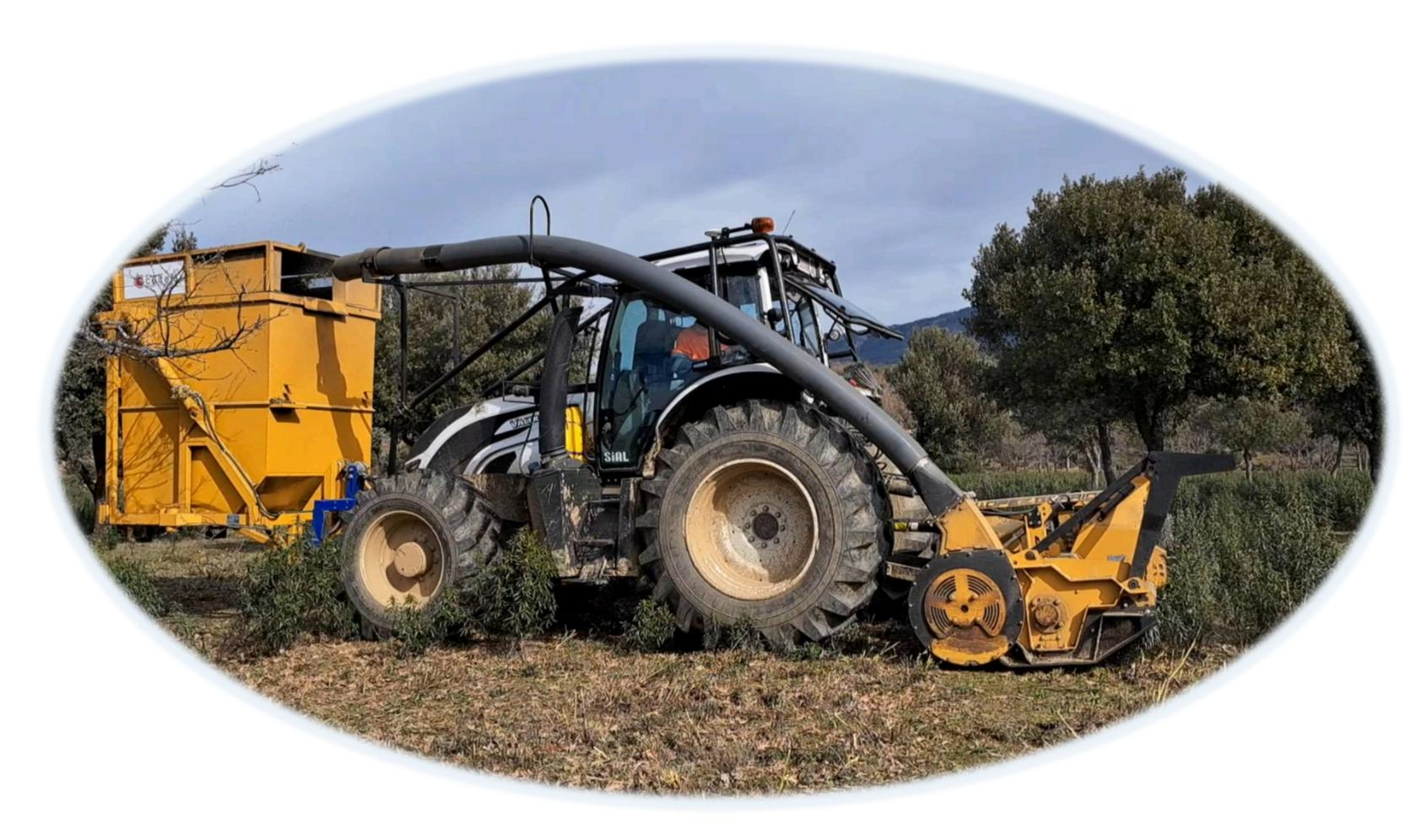
Cabezal desbrozador LG TBA 2300 de tambor horizontal con cuchillas oscilantes que corta la biomasa y la envía a un tornillo sinfín y este a una turbina que la impulsa a través de un tubo a un contenedor suspendido en el tripuntal delantero de un tractor Valtra de 200 Cv.
