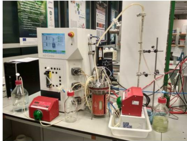
Figura 1: Montaje del biorreactor con el modo de operación en continuo. Incluye un sistema de filtración tangencial con membrana de fibra hueca para aumentar la producción de biomasa.
