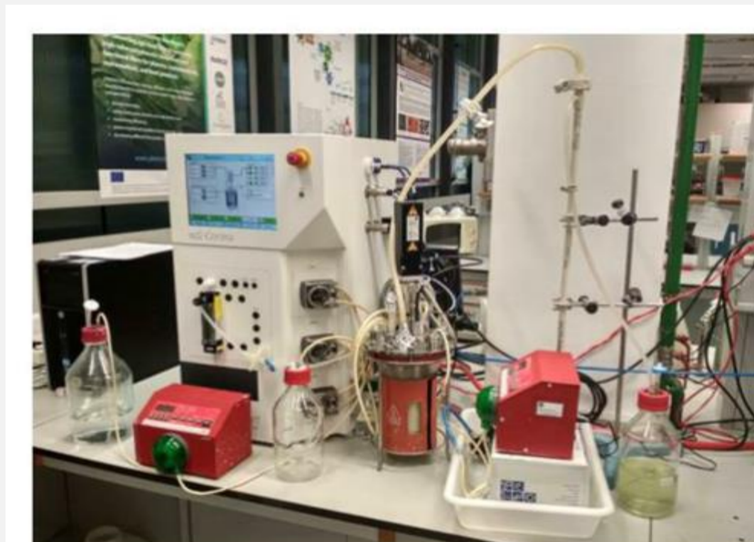
Figura 2: Biorreactor en continuo con microfiltración
