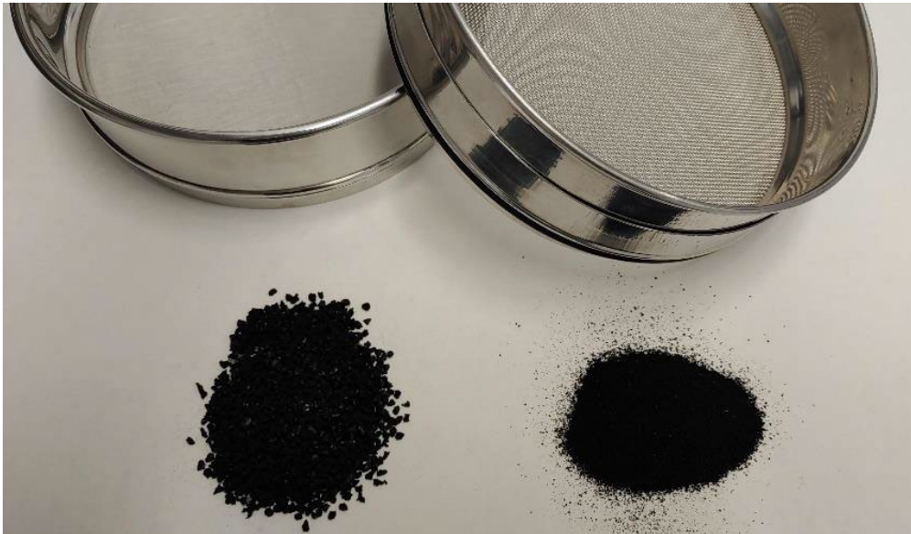
Figura 1. Ejemplos de granulado y polvo de caucho (SIGNUS).
