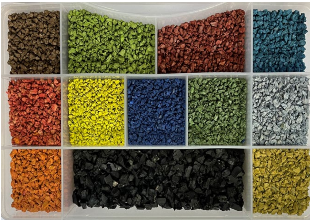
Figura 2. Ejemplos de granulado de caucho encapsulado (SIGNUS).
